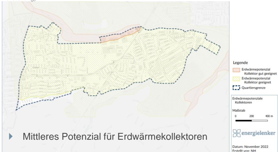
Bild 25: Erdwärmepotenzial-Kollektoren in Bergheim, Giebel, Wolfbusch (Quelle: LRGB, eigene Darstellung)
