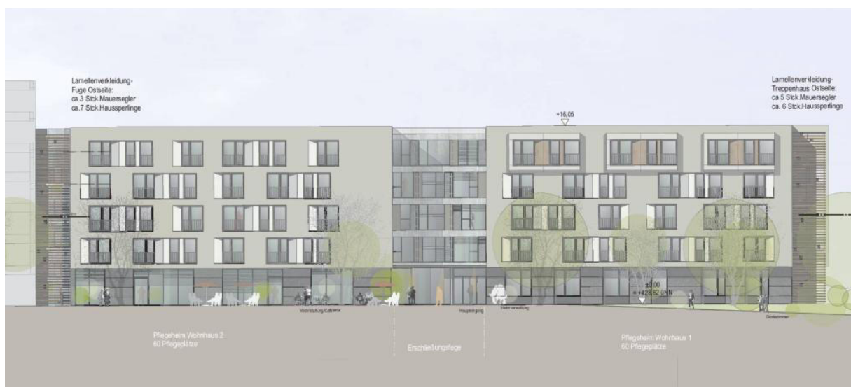
Abb. 5: Ostseite des Neubaus Pflegeheim mit ca. 8 Mauersegler- und 13 Haussperlingskästen in den Fugen der Lamellenverkleidung des Treppenhauses
