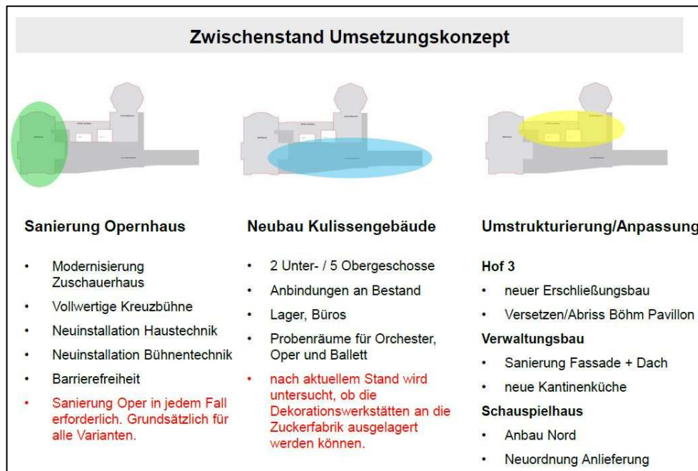
Abbildung 7: Übersicht Sanierungskonzept Variante A
