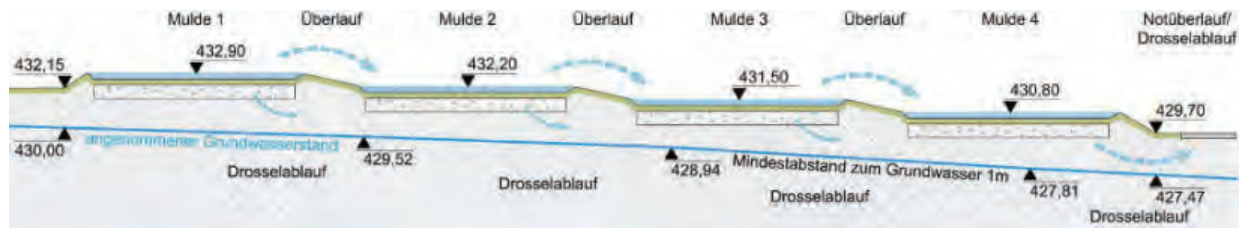
Schematischer Schnitt Szenario 3B - Aufbau eines Mulden-Rigolen-Systems mit Drosselablauf
